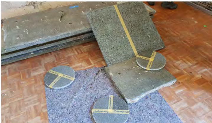
Abb. 11 Schulergänzungsbau, Bemusterung von Proben für die Sanierung der Terrazzoplatten, 2020 (Foto: LAKD M-V/LD, Sabine Schöfbeck).
